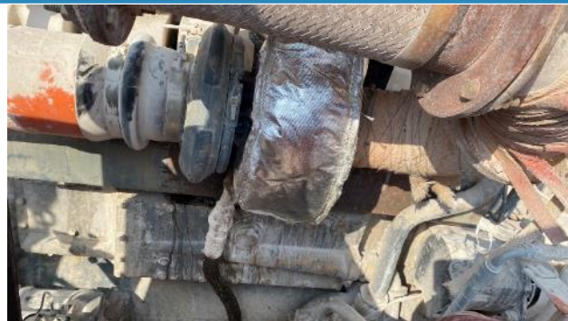
ตรวจเช็ค Jacket Turbo รถเจาะหิน
