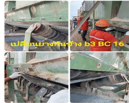
ตรวจสอบหน้างานเปลี่ยนยางกันข้าง B3BC54
